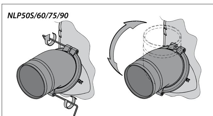
Om de slangen optimaal op de waterlock te kunnen aansluiten zijn beide slangaansluitingen 360° draaibaar.
