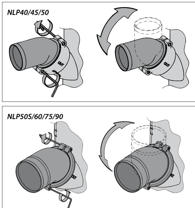
Con la finalidad de poder conectar de forma óptima las mangueras en el colector, **ambas** conexiones de manguera se pueden girar 360°.
