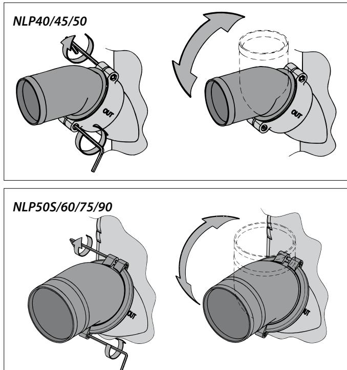
Beide Schlauchverbindungen sind um 360° drehbar, um die Schläuche optimal an den Wassersammler anschließen zu können.
