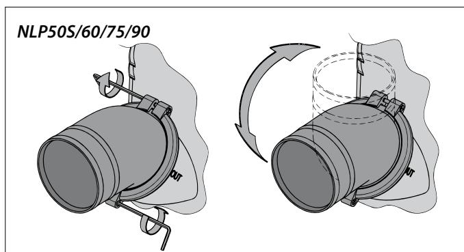
Pour assurer un raccord parfait des tuyaux sur le waterlock, les **deux** raccordements de tuyau peuvent tourner de 360°.
